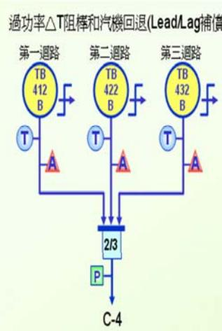
圖37-10 過功率 $\Delta T$ 反應爐跳脫及自動和手動阻棒抽出、汽機回退
