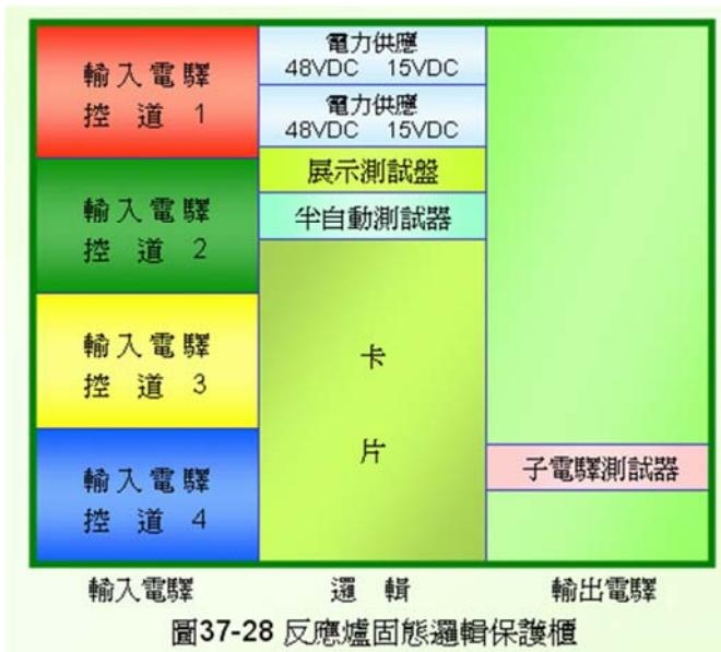
圖37-28 反應爐固態邏輯保護櫃
