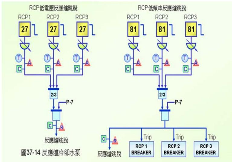
圖37-14 反應爐冷卻水泵
