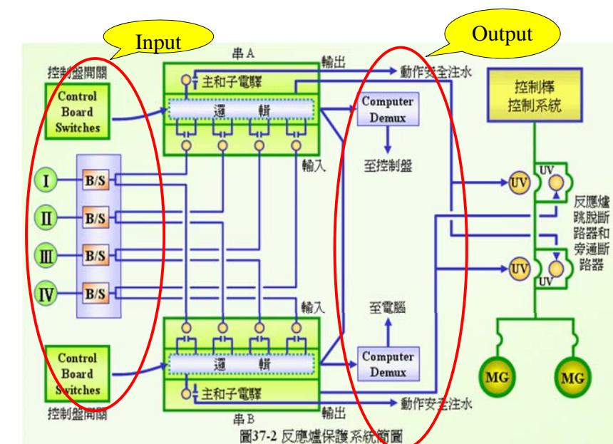
圖37-2 反應爐保護系統簡圖
