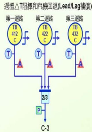
圖37-9 過溫 $\Delta T$ 反應爐跳脫及自動和手動阻棒抽出、汽機回退
